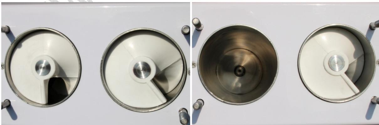
Nettoyez les 2 cylindres, les bacs de conservation et les mixeurs logés dans les cylindres avec de l'eau chaude et un détergent approprié.
