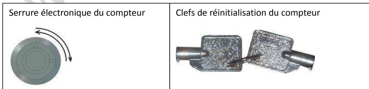
Les machines à glaces sont équipées de compteurs électroniques allant jusqu'à la valeur « 999 ». Les clés sont utilisées pour remettre le compteur à « 000 ». Pour réinitialiser le compteur, insérer la clé dans la serrure et tourner.
