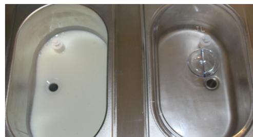
Dans la figure de droite, le réservoir de gauche n'est pas suffisamment rempli et doit être réapprovisionné. Le fonctionnement avec si peu de mix à crème glacée dans le bac risque d'endommager la machine. Figure de droite à gauche, le bac est vide et doit être réapprovisionné.
